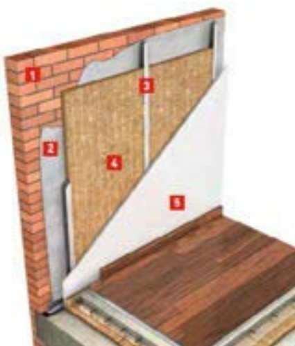
Trasdosado yeso laminado
